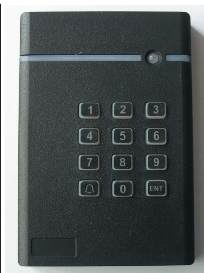
Рис. 1. Контроллер системы контроля доступа ELK-04
