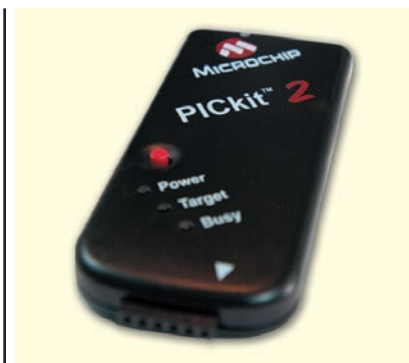
Рисунок 2 Недорогой внутрисхемный программатор-отладчик PICkit2
