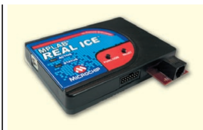
Рисунок 4 Hi-End отладочное оборудование компании Microchip
