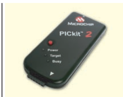
Рисунок 4 Недорогой внутрисхемный отладчик/программатор начального уровня PICkit2
