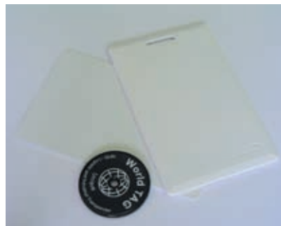
Рисунок 1 RFID карточки: тонкая, толстая и диск тег
