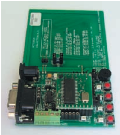
Рисунок 3 Отладочный комплект KitMicroDem-001 с установленным на нем модулем MM-005 фирмы Netronix
