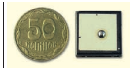
Рисунок 1 MG-S01SP со встроенной GPS антенной
