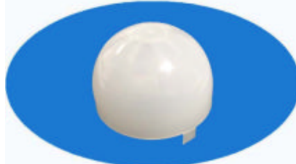
Type : NL-02 focus : 10.05 angle : 100 ° distance : 10m dimension : 23.5 high:12.30
