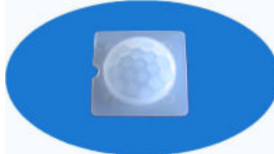
Type : 8307-2 focus : 12 angle : 60 ° distance : 3m dimension : 14
