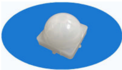
Type : NL-01 focus : 10.05 angle : 100 ° distance : 10m dimension : 24 high:14.00
